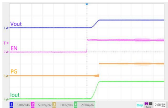
EN 开机 V_{OUT}=3.3V ， I_{OUT}=3A
