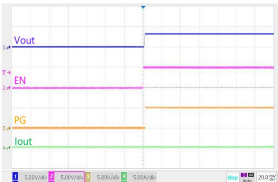
EN 开机 V_{OUT}=3.3V ， I_{OUT}=0A
